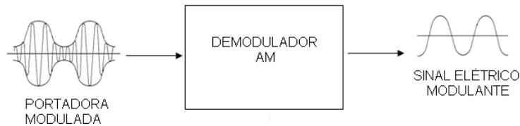
Figura 2: Receptor de AM ou demodulador de AM
