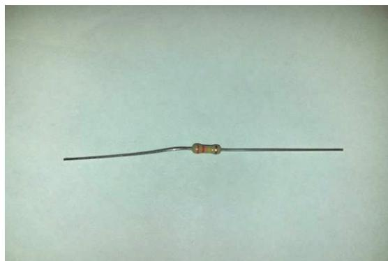
Figura 19: Resistor de  $330k\Omega$ .
