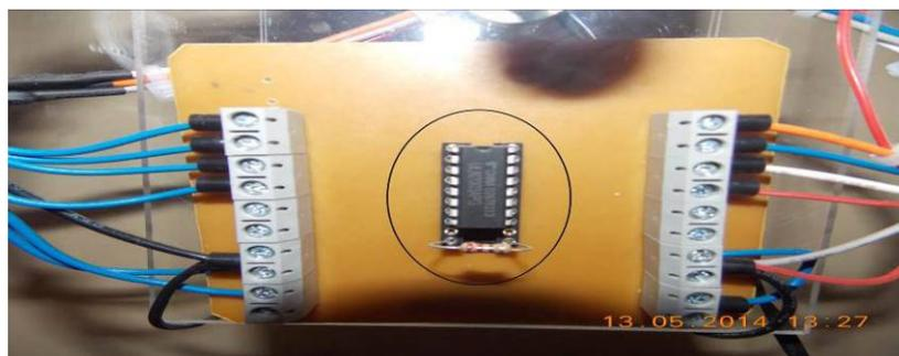
Figura 15 - Detalhe do driver de potencia na placa de C.I.
