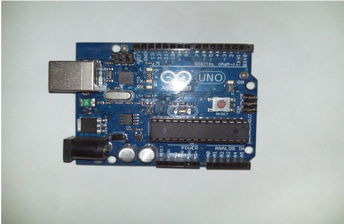
Figura 26: Microcontrolador Arduino.
