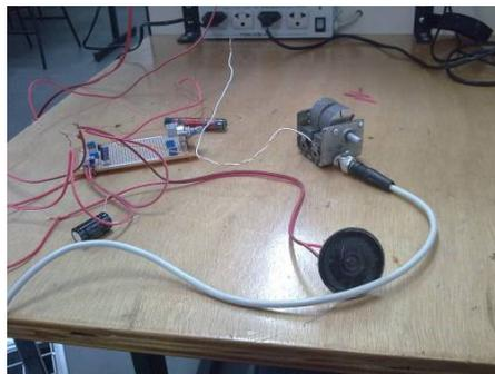
Figura 10: Visão geral do receptor AM em testes de bancada.
