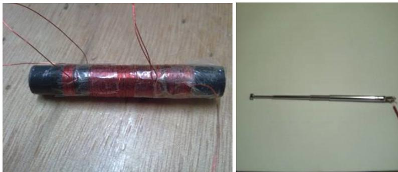
Figura 7 : Transformador e antena do receptor AM
