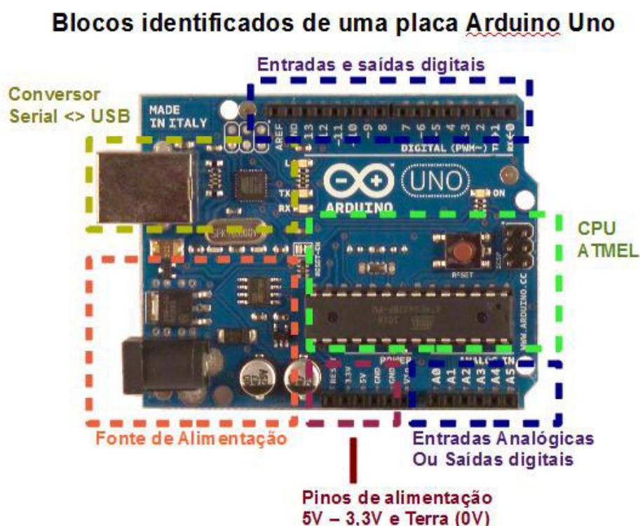
Figura 5: Bloco da placa do Arduino.
