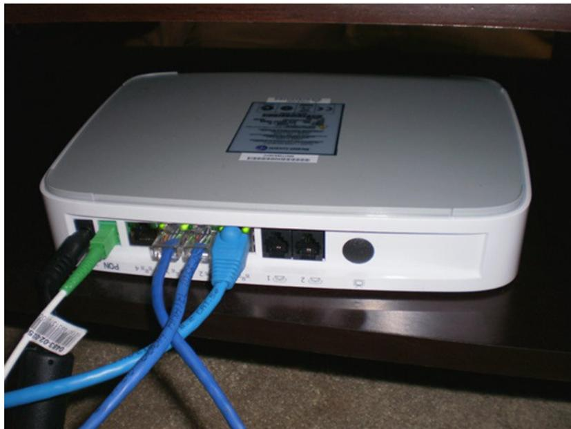
Figura 11: ONT (Optical Network Interface), um tipo de modem para fibra óptica.
