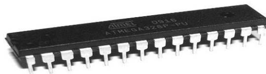
Figura 3: Microcontrolador Atmega328p.
